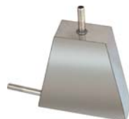
Теплообменник 290 × 390 × 150 × 80 мм Материал – сталь AISI409, 1,5 мм
