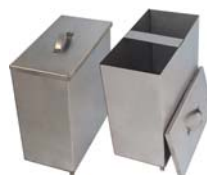
Бак (нерж.) 60 л – 500 × 505 × 250 мм 80 л – 500 × 550 × 300 мм 100 л – 500 × 600 × 350 мм 120 л – 500 × 705 × 350 мм Материал – AISI409, 1 мм
